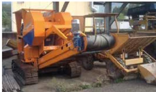
E un frantoio mobile che permette il riciclo di inerti direttamente nei cantieri poco accessibili.
